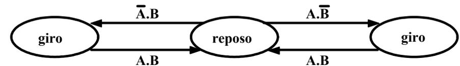
Ahora bien, los dos estados de *giro* tienen el mismo vector de salida (el motor girando en el mismo sentido) y la misma transición de salida (con A.B pasan al reposo); por ello, equivalen a un solo estado:
