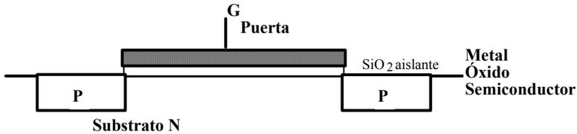
Cuando la tensión de entrada  $V_i$  es suficientemente negativa, la puerta atrae a los huecos libres en el sustrato (procedentes de los pares electrón-hueco propios del silicio como semiconductor) y forma un canal conductor entre fuente y drenaje; cuando la tensión de puerta es claramente inferior a la tensión umbral, no existe canal y el transistor no conduce.
