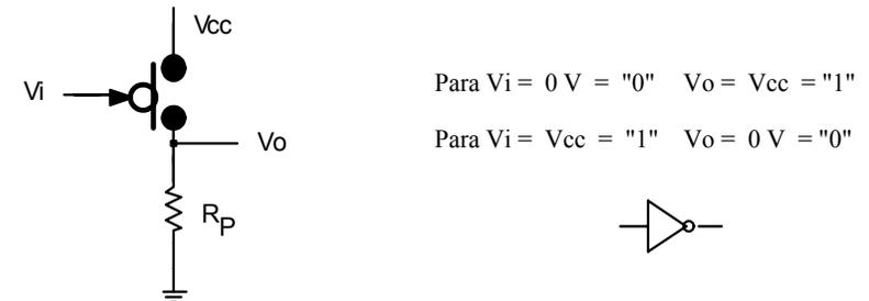
El montaje anterior es inversor ya que el interruptor conduce cuando recibe un **0** y, entonces, lleva la salida a **1**; la resistencia  $R_P$  transmite por defecto (cuando el interruptor no conduce) la tensión correspondiente a **0**.
