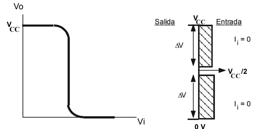
La resistencia de salida para el valor **1** es la que presenta el transistor PMOS y para el **0** la correspondiente al transistor NMOS, ambas muy bajas ( $\sim 10 \Omega$ ) por el propio diseño de los transistores, adecuadamente anchos.
