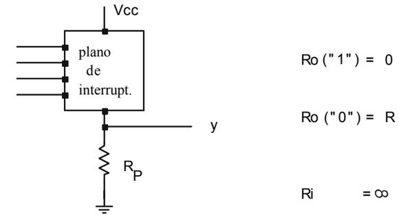
El buen acoplo en tensión queda garantizado por ser  $R_i \approx \infty$ .
