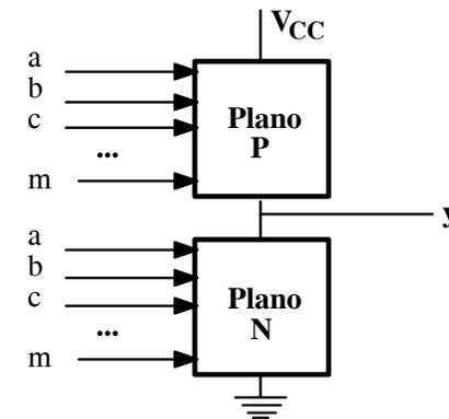
Todo transistor de canal N debe estar acompañado por un complementario de canal P: las combinaciones de los PMOS han de ser duales (paralelo ↔ serie) respecto a las que forman sus correspondientes NMOS, a fin de que la salida se encuentre siempre conectada a 0 o a V<sub>CC</sub> a través de transistores activos.
