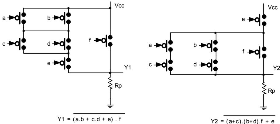
Las puertas resultantes son siempre inversoras: producen una inversión global sobre el conjunto de operaciones "y" (paralelo) y operaciones "o" (serie) configuradas por la forma de conexión de los interruptores; todas ellas proceden de la estructura de un inversor y conservan tal carácter.
