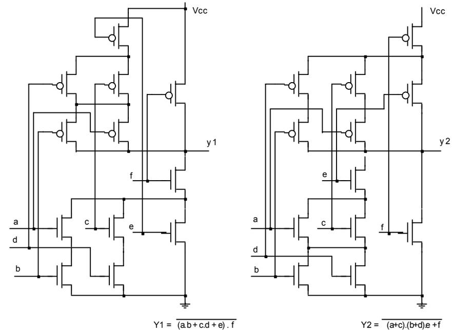
Las puertas lógicas CMOS se construyen mediante dos planos «duals» de transistores: **plano N** y **plano P**; a cada una de las entradas le corresponden sendos transistores, uno en cada plano, conectados de acuerdo con la dualidad serie-paralelo.
