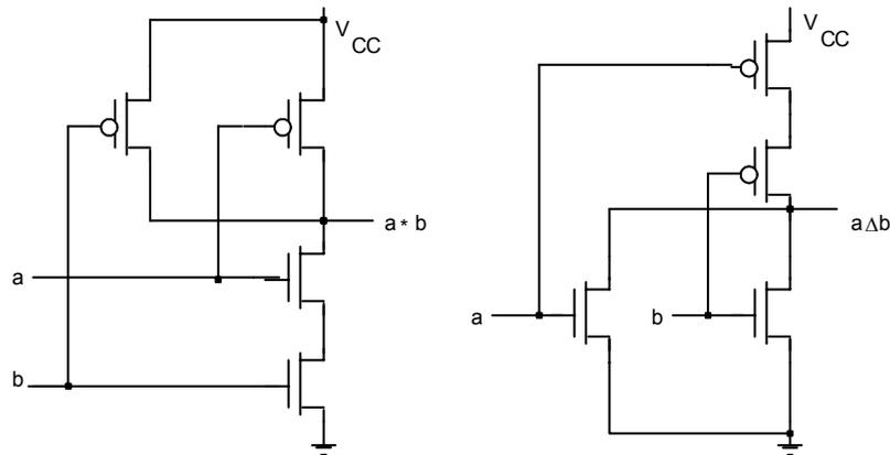
Estas puertas inversoras, conformadas con transistores «MOS complementarios» dan lugar a la familia lógica CMOS, con un «plano PMOS» superior y otro «plano NMOS» inferior, ambos con el mismo número de transistores y en conexión «dual» en un plano respecto al otro: si dos transistores de un plano se encuentran en serie, los correspondientes complementarios en el otro plano se encontrarán en paralelo.
