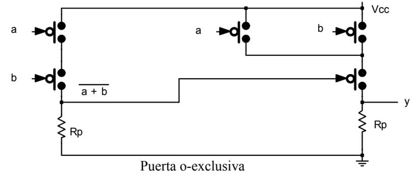
En resumen, una puerta con interruptores inversos estará conformada por un «plano de interruptores», conectados en serie o en paralelo para configurar operaciones "o" y operaciones "y", respectivamente, y por una resistencia de polarización Rp:
