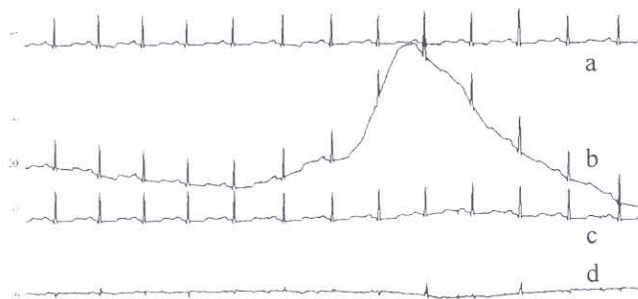
Figura 4. Señal original (a), contaminada con señal de movimiento muscular (b), recuperada con filtros adaptativos (c) y error de estimación (d).
