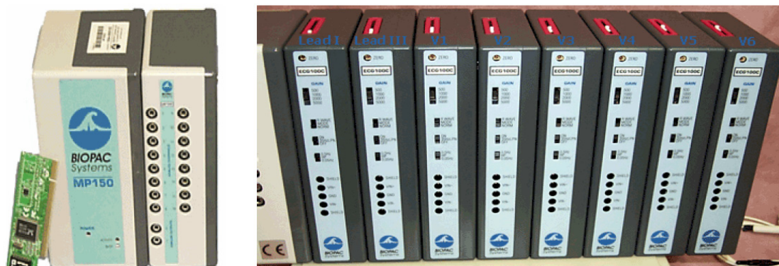
Figura 5.1: Unidad de adquisición MP150, interfaz UIM100C, tarjeta Ethernet (izquierda) y los 8 amplificadores específicos ECG100C necesarios para registrar la señal ECG de 12 derivaciones (derecha).
