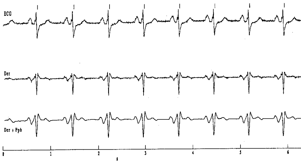
Figura 3.6: Detección de complejos QRS en una señal ECG.
