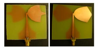
Fig. 4. Prototipos de antenas CC-PS y EL-PS
