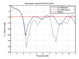
Fig. 5. Comparativa entre resultados experimentales y simulación para antena CC-PS
