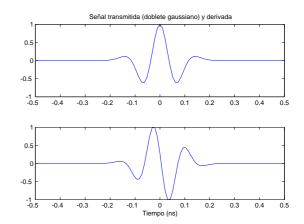
Fig. 9. Señal transmitida y su derivada normalizadas
