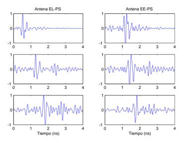
Fig. 10. Señales recibidas para varias direcciones  $(0,45,90^{\rm o})$
