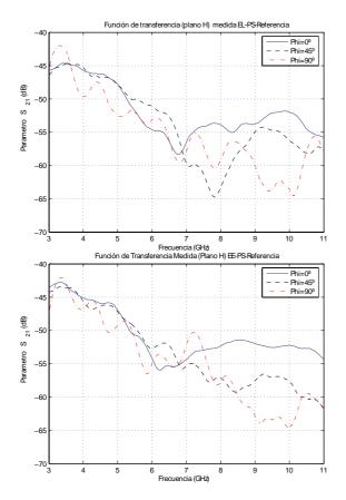
Fig. 8. Funciones de Transferencia Experimentales  $(S_{21})$  EL-PS y EE-PS
