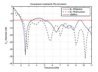
Fig. 6. Comparativa entre resultados experimentales y simulación para antena EL-PS
